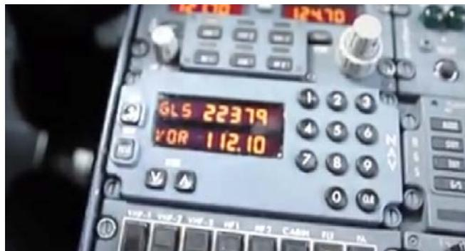
Ces deux types d'augmentation nécessitent un équipement embarqué spécifique: un récepteur GPS WAAS pour les approches SBAS et un récepteur VHF GBAS (VDF) pour les approches GLS.
