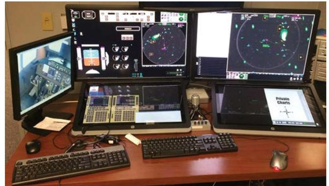
Mais il peut également visualiser instantanément l'état de chacun des appareils, avec une recopie virtuelle des instruments de bord (paramètres primaires de vol, niveau d'automatismes, état machine, informations FMS).
