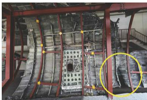
À gauche : Preuve de la rupture envol du fuselage.
